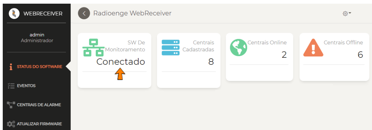
Figura 70: WebReceiver conectado ao software de monitoramento
