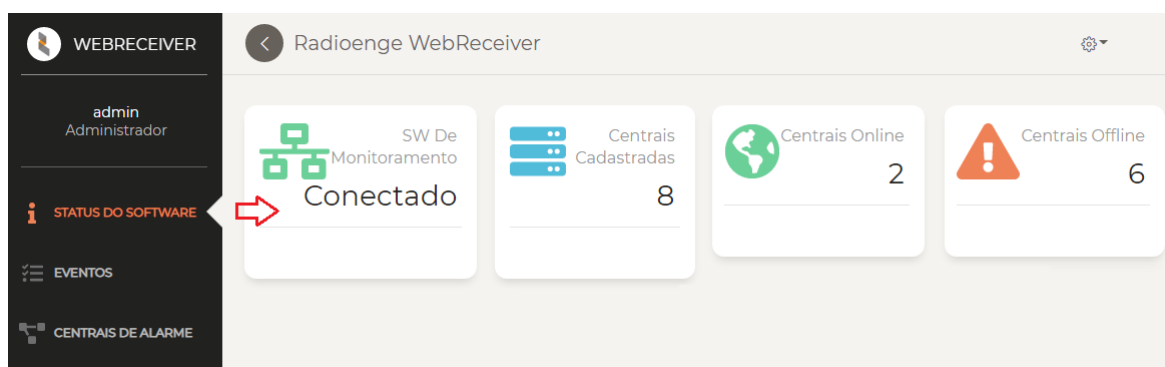
Figura 69: WebReceiver conectado ao software de monitoramento
