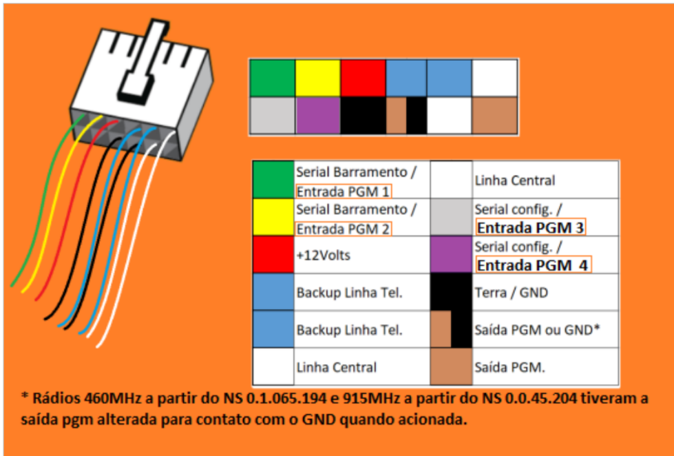
Figura 29: Fios do chicote elétrico para conexão das entradas PGM
