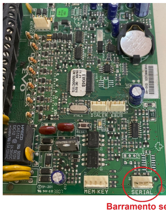
Figura 3: Barramento serial da central Paradox EVO 48
